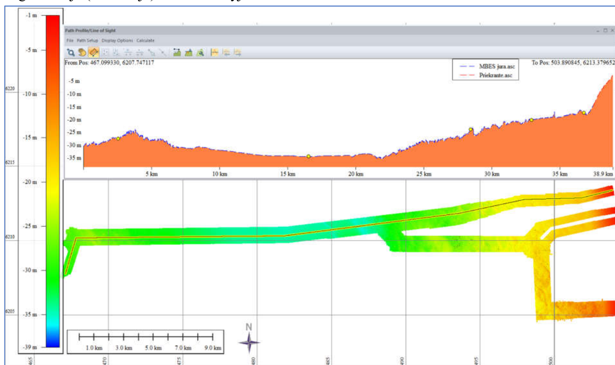
12 pav. Jūros gylių schema ir išilginis reljefo profilis
